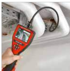
Inspección de espacios huecos
