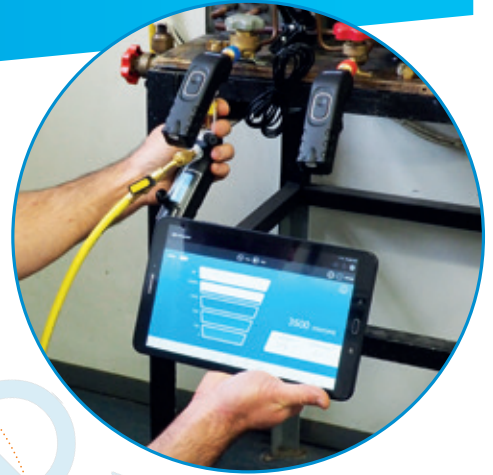
MEDICIÓN DEL VACÍO CON EL VACUÓMETRO SI-RV3
