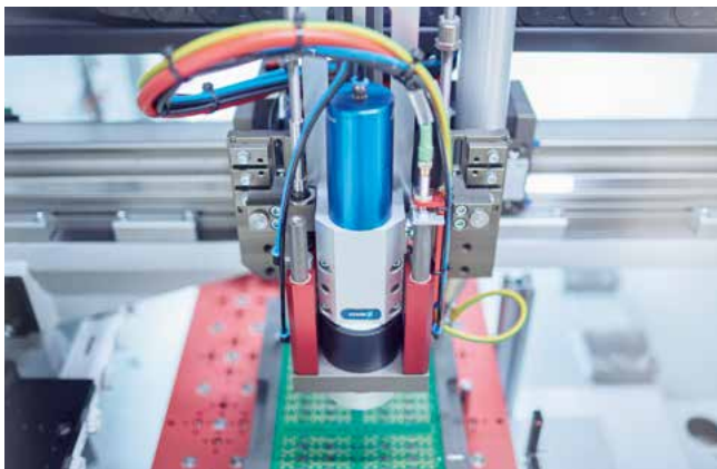
Die Grundausstattung besteht aus einem Frässpindelmodul. Optional kann der Fräskopf mit einem Visionsystem oder Scanner ausgerüstet werden. The basic configuration consists of a milling bit module. As optional expansion of the base system, the milling bit module is available with vision system as well as with scanner.
