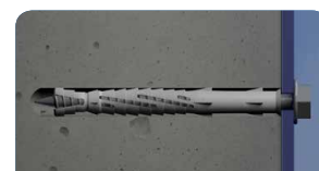
6. A bucha está instalada
