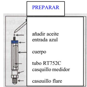
3. Abrir la válvula de la fuente de gas para presurizar el Checkmate.
